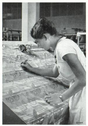
Le compteur métrique Hasler, monté sur un métier de contrôle de tissus de la fabrique de machines Rüti S. A., est un compteur totalisateur qui se prête spécialement pour des machines rapides et pour déterminer la longueur des tissus dans l'industrie textile (Hasler S. A., Berne)
