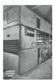
illustrés par des photographies et des échantillons de tissus. Dans ce système, le tissu à imprimer passe autour d'un cylindre, le cadre d'impression sortant d'un magasin pour passer plusieurs fois sur le cylindres. La racle est fixe. La machine est prévue pour une largeur utile normale de 1,4 m. et pour 1 à 6 couleurs.
