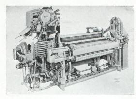
Métier automatique Banxtw-6 à 6 boîtes montantes d'un côté, avec changement automatique de la canette pour 4 couleurs, pour grands rapports et fils fantaisie, particulièrement intéressant pour les tissages dont la production est sujette aux fréquents changements de la mode (Ateliers de Construction de Rüti S. A., Rüti-ZH)
