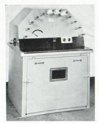
Machine pour ôter et délier économiquement les restes de fil se trouvant sur les tubes de bancs à broches. L'ouverture des mèches est parfaite, ne causant pas le moindre dommage aux bobbins ni aux fibres (Ateliers de construction de Bäch S. A., Bäch)
