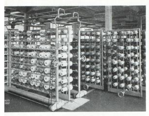
Cantre-Rüti, type GLWK: ce cantre à éléments de frein commandés par le vide et avec chariot de bobines mobiles se distingue par un freinage extrêmement doux qui peut être adapté sans interruption et d'une place centrale. Le même cantre est également livré pour bobines à marche continue (Ateliers de construction de Rüti S. A., Rüti-ZH)
