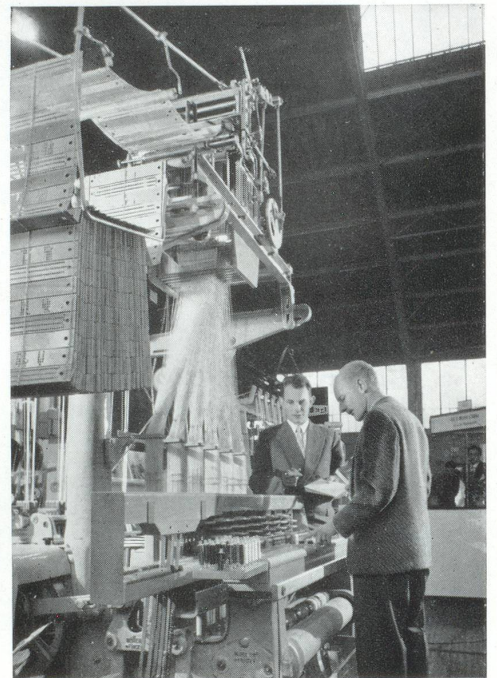
Un métier jacquard à tisser les rubans, dans la section des machines textiles
