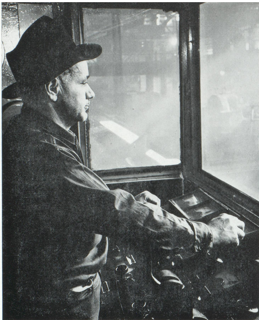
L'automation dans l'industrie américaine. Dans cette aciérie, un opérateur contrôle de son pupitre le mouvement des barres d'acier qui passent dans les laminoirs
