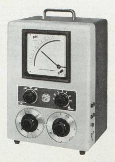
pH-mètre de précision à compensateur par gradins et indication directe dans l'étendue de 2 pH, avec prise pour enregistreur et titration Karl Fischer; précision de mesure  $\pm$  0,01 pH. Polymetron S. A., Zurich
