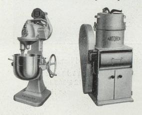
faire en acier inoxydable. Et notons encore les batteurs-mélangeurs de toutes grandeurs, livrables en exécution normale avec bassine à double-fond pour chauffage électrique ou à vapeur, ainsi que bassines et outils en acier inoxydable.
