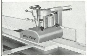
Nouvelle machine brevetée pour percer les nœuds
