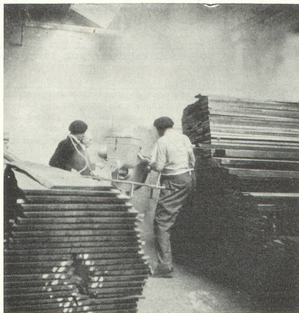
Poudrage d'un stock de sciages contre les piqûres d'insectes
