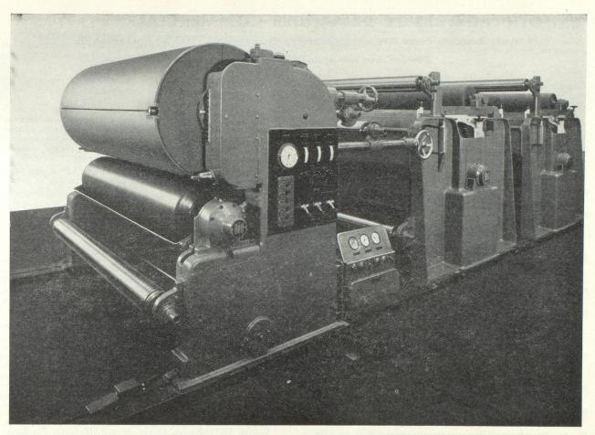
Machine enrouleuse pour la fabrication du carton, avec deux formes rondes et coupage automatique.
