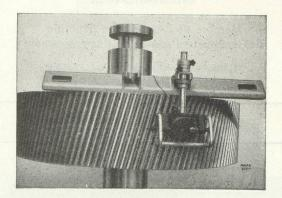
Appareil type HMV à mesurer l'angle d'hélice des grands engrenages
