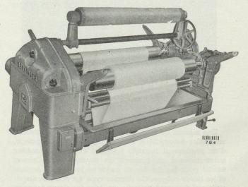
$\label{eq:machine} Machine~automatique~\grave{a}~blanchir~et~\grave{a}~teindre~au~large,~mod\`{e}le~FFM,\\ avec~\'{e}largisseur~\grave{a}~bascule~et~dispositif~exprimeur~renversable$
