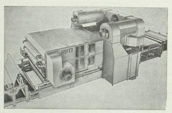
Encolleuse à haute production, à chambre de séchage réglable
