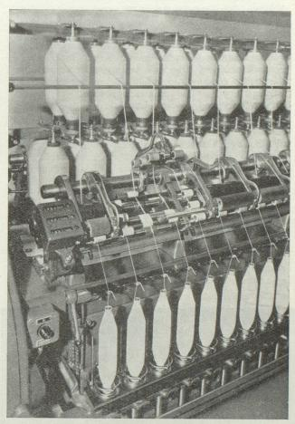
Continu à filer à porte-broches mobiles spécialement étudié pour le filage des numéros gros et moyens, muni d'un système de sousrenvidage et d'arrêt automatiques ainsi que du graissage central,
