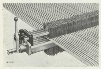
Le nouvel appareil casse-fils électrique KFW 1.000. A la casse d'un fil de chaîne, il arrête instantanément le métier; il en est donc le gardien infaillible
