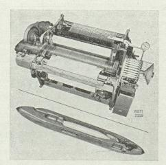
Métier automatique à une navette modèle BANLXK, à grande vitesse, avec navette brevetée à pincement sans ressort et canette sans anneaux
