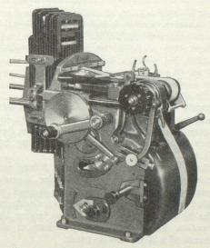
Métier à tisser les rubans à passage unique Saurer, type 60B, travaillant avec 300 coups-minute, pour 60 millimètres de largeur maximum du ruban
