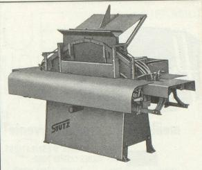
Machines à nettoyer les tubes avec dispositif à couper les fils qui sépare les tubes Machines à nettoyer les tubes type Flyer Machines brevetées pour enlever les restes de trame de tout les tubes de filature et de tissage
