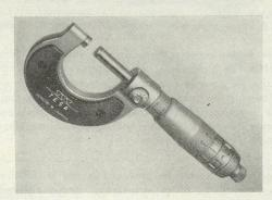
Micromètre « Micromaster » pour lectures de 0 à 25 millimètres (Tesa SA, Renens)
