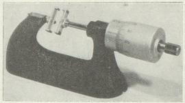
Porte-fils pour la mesuration rapide du diamètre sur flancs de pièces filetées (Tavannes Machines et C¹º SA, Tavannes)
