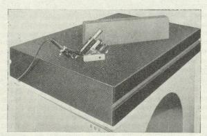
Marbre et règle à dresser avec instrument de contrôle de surface (cliché de la Tesa SA à Renens)
