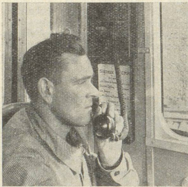
Téléphone dans la cabine d'une locomotive électrique
