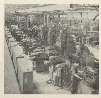
Une machine « transfert » et ses têtes « électro-mécaniques ».
