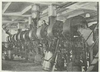
Dans une grande usine de produits chimiques et pharmaceutiques à Bâle : installation de mélange et de broyage (Photo Ciba)
