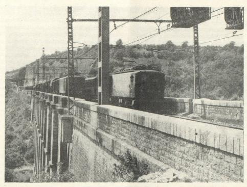
Deux trains se dépassant sur la section banalisée Blaisy-Bas-Dijon. Sur cette section, constituant l'accès côté sud du seuil de Bourgogne, les voies peuvent être empruntées dans les deux sens de circulation, afin de faciliter le débit de la section. L'accès côté nord du seuil de Bourgogne comporte quatre voies.
