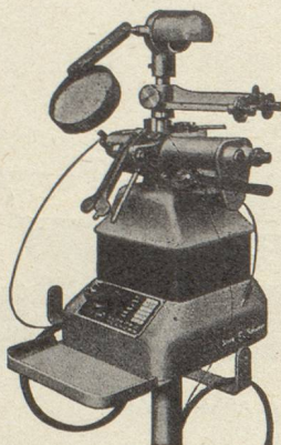
Machine à souder bout à bout type S, pour fils 0,3 - 2 mm. de diamètre
