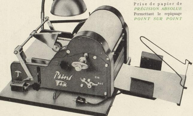
Cette machine, dernière née de la technique suisse, grâce à son ENCRAGE AUTOMATIQUE, et à sa PRISE DE PAPIER spéciale, permet d'imprimer avec une régularité parfaite 3 à 6.000 exemplaires à l'heure, sur tous papiers et cartons, depuis le format 10×15 au 21×36
