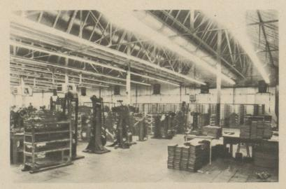
ECLAIRACE PAR TUBES FLUORESCENTS D'UN ATELIER DE MECANIQUE. — L'atelier est entièrement dans la lumière. Les machines, aussi bien que les dégagements, sont bien éclairés. (Photo Philips.)
