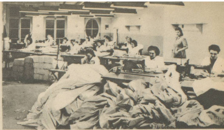
ECLAIRAGE D'UN ATELIER DE COUTURE PAR TUBES FLUORESCENTS. — La répartition des appareils permet la suppression des ombres sur les machines. (Photo Philips.)
