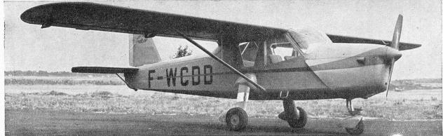
MORANE-SAULNIER 560 moteurs de 220 cv. accouplés à l'intérieur du fuselage et entraînant deux hélices co-axiales.
