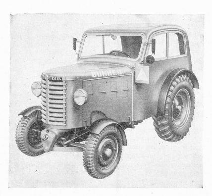
TRACTEUR ROUTIER BUHRER A MOTEUR DIESEL 3 CYLINDRES
