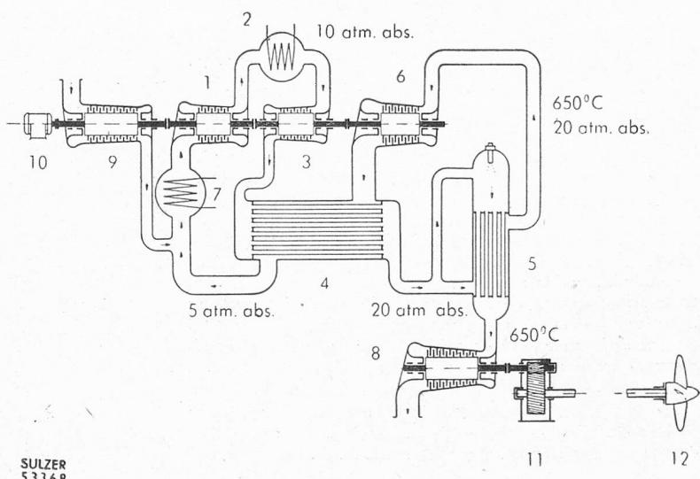
d'air 5, et portée à la température limite supérieure du cycle, soit par exemple 650° C. L'air est ensuite détendu jusqu'à 5 atm. dans la turbine 6, après quoi il cède, dans le récupérateur 4, une partie de sa chaleur restante à l'air comprimé, tandis que le reste de la chaleur contenue est évacuée au moyen du réfrigérateur 7. L'air ainsi refroidi gagne de nouveau le compresseur basse pression 1, opérant ainsi un premier cycle.
