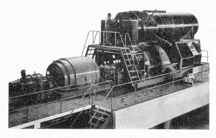
puissance restante est communiquée à la génératrice électrique, soit directement, soit par l'intermédiaire d'un réducteur de vitesse. Un moteur de démarrage est accouplé en bout d'arbre de la génératrice pour l'entraînement des groupes à une vitesse suffisante permettant l'allumage. Le rendement thermique aux bornes de l'alternateur d'une installation à turbine à combustion de 1.250 kw. ainsi constituée est d'environ 15 p. 100.
