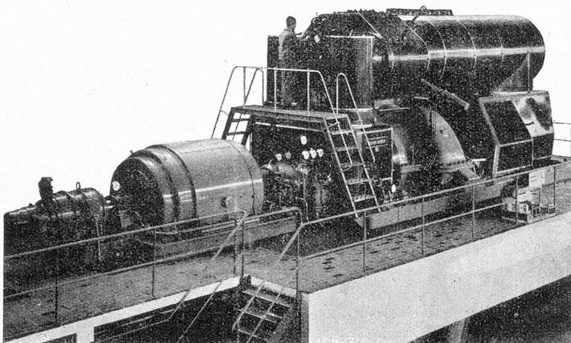
puissance restante est communiquée à la génératrice électrique, soit directement, soit par l'intermédiaire d'un réducteur de vitesse. Un moteur de démarrage est accouplé en bout d'arbre de la génératrice pour l'entraînement des groupes à une vitesse suffisante permettant l'allumage. Le rendement thermique aux bornes de l'alternateur d'une installation à turbine à combustion de 1.250 kw. ainsi constituée est d'environ 15 p. 100.
