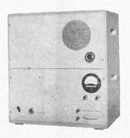
Vue d'une station du système Radiovox avec dispositif acoustique (protégé par une grille) et organe de contrôle monté dans la station
