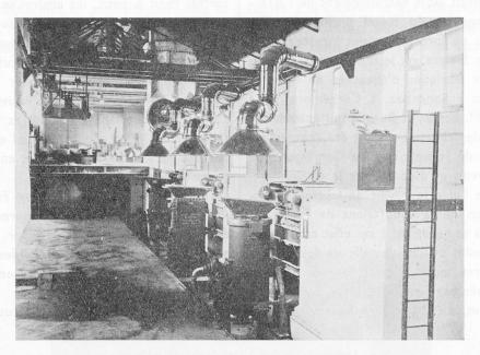
Batterie de fours électriques à fusion
