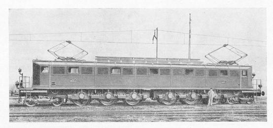
Fig. 7. — Locomotive électrique de 5.400 chevaux de la Cie de Chemins de Fer Paris-Lyon-Méditerranée
