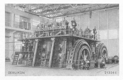
Fig. 4. — Groupe diesel-électrique de la Société Française de Tramways et Eclairage Electrique de Shanghaï, puissance unitaire 5.000 K. V. A.
