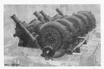
Turbines Spirales du Sautet. Puissance : 17.150 à 6.600 CV.
