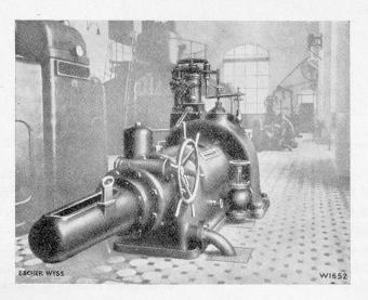
Vanne-Papillon pour turbine spirale de grand diamètre Constructeur : Escher-Wyss
