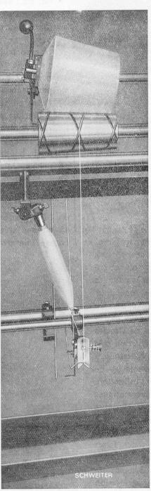
branche, nous citerons en premier lieu un bobinoir mécanique à grande vitesse, pour bobines à fil croisé de 2 à 3 kilos de poids total, tel qu'il est utilisé depuis peu de temps dans l'ourdissage. La machine peut être employée pour les fils les plus variés: coton, laine, lin, schappe, etc., et atteint des vitesses de 600 mètres de fil par minute.
