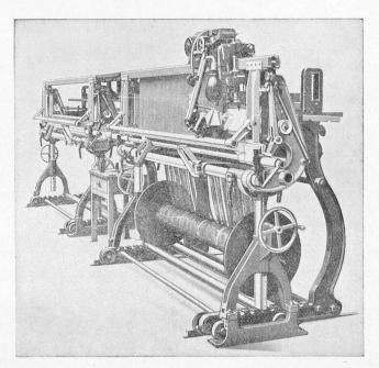
Fig. 4. — Machine à nouer universelle
