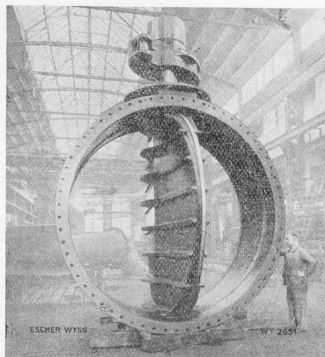
Vanne-Papillon pour turbine spirale de grand diamètre Constructeur : Escher-Wyss
