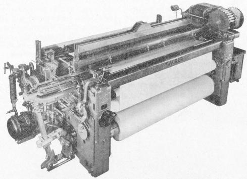
Fig. 7. — Métier automatique de construction très basse
