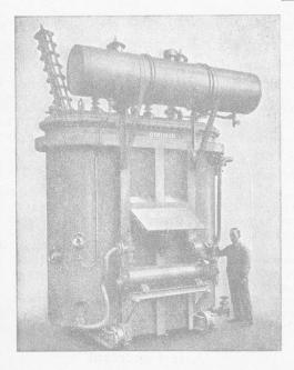
TRANSFORMATEUR POUR EXTÉRIEURS 3000 KVA. 11500/23500 VDTS AVEC CONSERVATEUR ET RÉFRIGÉRAN!
