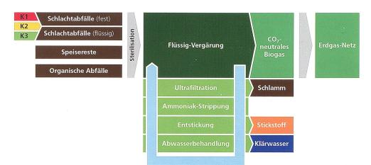
Verfahrens-Schema der Biogasproduktion.
