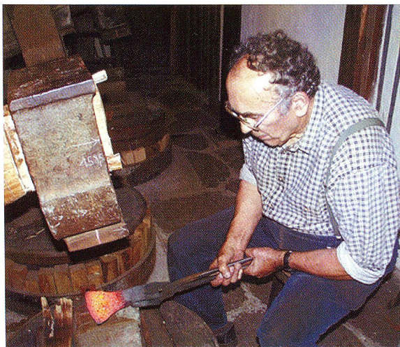
Schmieden eines Beiles im alten Hammerwerk
