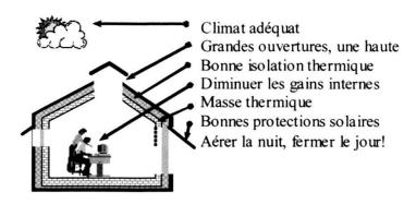
Figure 7: Conditions nécessaires pour un refroidissement passif efficace
