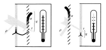
Figure 5: Les protections solaires efficaces sont à l'extérieur du bâtiment. En effet, le rayonnement solaire chauffe la protection et cette chaleur doit être évacuée à l'extérieur en été.
