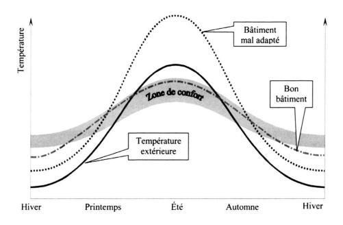
Figure 3: Évolution des températures dans des bâtiments au cours de l'année, en absence de chauffage ou de climatisation.
