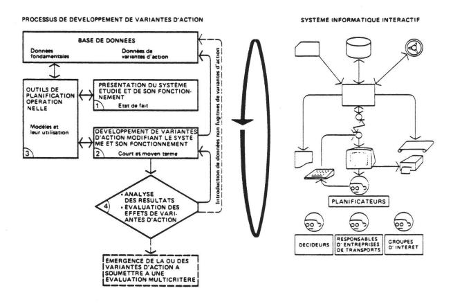
Figure 4: Processus de planification opérationnelle d'un système de transport ou de ses composants.
