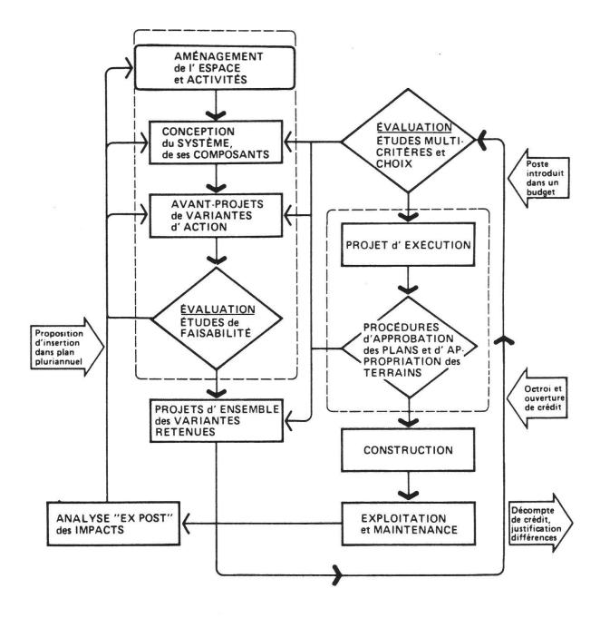
Figure 1: Phases de conception, de préparation des décisions de réalisation et d'exploitation d'un système civil.
