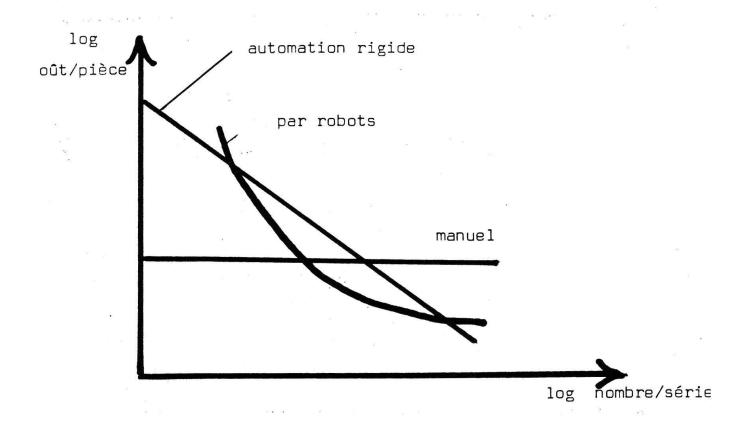
Fig. 1: Coût par pièce en fonction du nombre monté par série.
