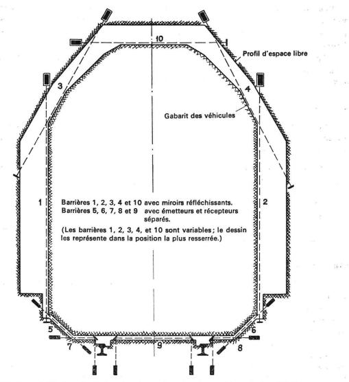
Principe du contrôle de gabarit. Les émetteurs, les récepteurs et les miroirs réfléchissants peuvent être légèrement chauffés à l'électricité.
