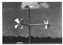
Le système anémométrique NEZ (Nord-Est-Zénith) à axes cartésiens permet la mesure instantanée des composantes du vecteur vent sous forme digitale en vue d'un traitement automatique des données sur ordinateur.
