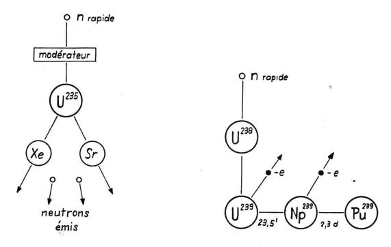
Fig. 2. Schéma de la fission de l'uranium 235. Sous le choc d'un neutron le noyau se brise en deux fragments inégaux (par exemple strontium et xenon) et émet deux ou trois nouveaux neutrons.
