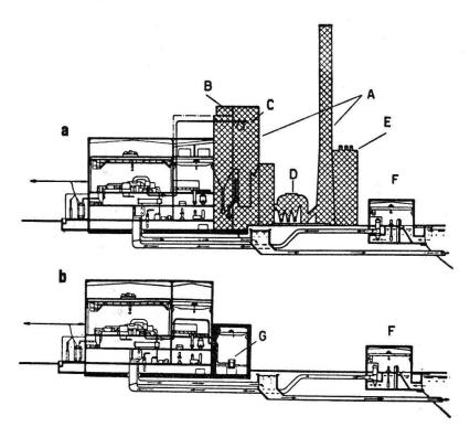
Fig. 12. Comparaison entre une centrale thermique à charbon ou nucléaire. Les parties thermiques et électriques sont identiques. La chaudière C, les silos à charbon B, les séparateurs de poussières D, la cheminée A et les silos à cendre E sont remplacés par le petit réacteur G. En F la station de pompage de l'eau de refroidissement.
