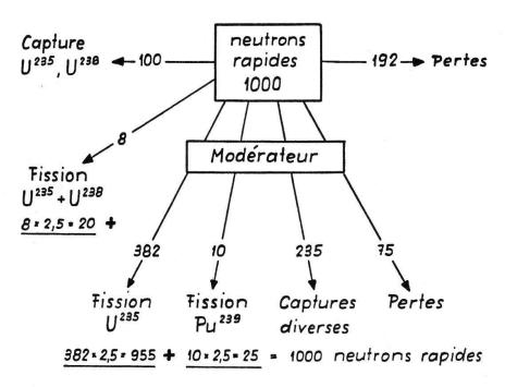
Fig. 4. Bilan des neutrons dans un réacteur en régime permanent. Les neutrons produits par la fission compensent exactement les neutrons initiaux et les pertes et captures parasites.
