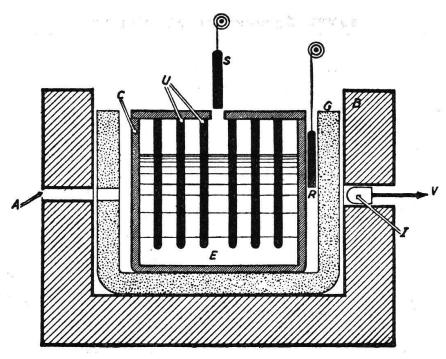
Fig. 5. Schéma d'un réacteur nucléaire à eau lourde. Les barres d'uranium U plongent dans le réservoir C d'eau lourde E. Un réflecteur en graphite G réduit les fuites de neutrons vers l'extérieur. Des barres de réglage en bore ou cadmium permettent de limiter la puissance dégagée par absorption de neutrons. La protection contre les radiations est assurée par le bloc de béton B.
