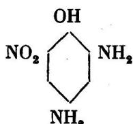
où nous voyons un OH et deux NH<sub>2</sub> en positions 1, 2, 4, cad. ortho et para, positions requises dans la fonction révélatrice.
