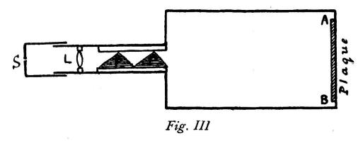
petit spectroscope à vision directe d'où les rayons émergent parallèlement des lentilles du collimateur L. PP est un prisme composé qui projette le spectre sur la plaque AB. Le châssis renfermant la plaque est généralement fait de façon à pouvoir glisser horizontalement, ce qui permet trois ou quatre expositions les unes à côté des autres, sur la même plaque.
