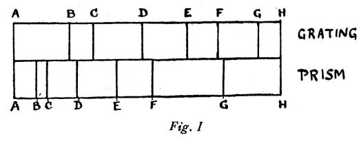
spectre: a) au moyen d'un prisme, b) au moyen d'un réseau de diffraction (Grating).
