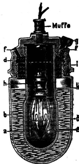
On remplit la lampe par le petit entonnoir ou en dévissant l'am-poule extérieure *b*. Si l'on utilise la lampe pendant un temps prolongé, la solution se chauffe et il se vaporise, par heure de marche, environ 2 gr. d'eau. La construction de la lampe permet une évaporation d'environ un quart du volume entier du liquide sans qu'on ait à craindre la pénétration, dans la chambre noire, d'une lumière fausse. La lampe présente, par ce fait, une grande sûreté dans la durée du fonctionnement.
