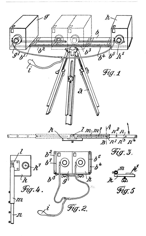
l'aide d'écrous permettant de les y fixer à un écartement variable et les graduations dont est pourvue la glissière permettent de placer toujours les deux chambres à une même distance du point de vue (centre de la glissière).
