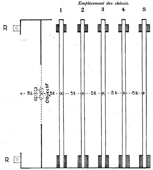
Fig. 1. – Schéma de l'appareil pour photographies metriques.
