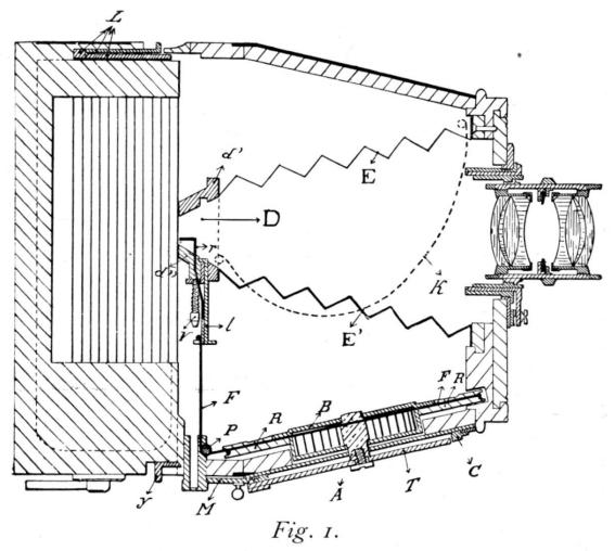
L'écartement des couteaux peut être modifié par l'action d'une vis micrométrique V, au pas de o<sup>mm</sup>5, dont la tête carrée vient, quand l'obturateur est à bout de course, s'encastrer dans un petit arbre creux que commande une manette M, extérieure à l'appareil; à chaque tour de cette manette, dans un sens ou dans l'autre, la fente augmente ou diminue d'un demi-millimètre; nous verrons tout à l'heure comment sa largeur est à chaque instant connue de l'opérateur.
