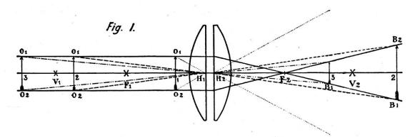
Konstruktion des Bildortes (Fig. 1) zwei Punkte auf der Achse innerhalb der Linsenmasse und zwei in ihnen auf der Achse senkrecht stehende Ebenen notwendig sind — die Hauptpunkte  $H_1$  und  $H_2$  und die beiden Hauptebenen — ferner die beiden Brennpunkte  $F_1$  und  $F_2$ , welche so liegen, dass  $H_1F_1 = H_2F_2$  ist.
