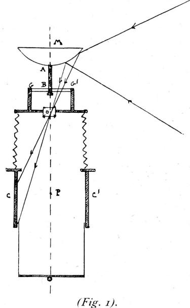
En somme, des objets situés autour de l'appareil, la sphère réfléchissante donnerait une première image, virtuelle et déformée; de celle-ci, l'objectif fournirait sur le cylindre une deuxième image, réelle et également déformée; mais M. Ducos du Hauron estime que les déformations se compenseraient exactement et que l'image cylindrique, vue d'un
