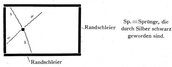
Die Sprünge ziehen sich als schwarze Linien durch den hellen Grund. Betrachtet man die Sprünge mit dem Mikroskop, so sieht man, dass das Silber in kleinen Anhäufungen vorhanden ist, die nun wie die Perlen eines Rosenkranzes aneinander liegen:
