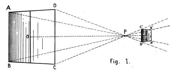
Stellt man in den Strahlengang hinter den Kreuzungspunkt einen Schirm, so wird auf diesem durch jeden Strahl ein Punkt markiert, welcher als Bildpunkt zu dem Ausgangspunkte des Strahles gehört. Im ganzen entsteht so, rein geometrisch, ein umgekehrtes, flächenartig ausgebreitetes Bild des Gegenstandes; P ist der Augenpunkt.
