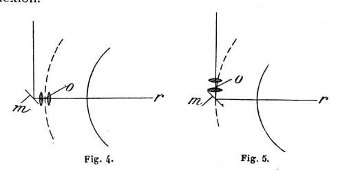
Ce miroir peut être placé soit en avant (fig. 4) soit en arrière (fig. 5), de l'objectif, à 45° de son axe principal. Nous
