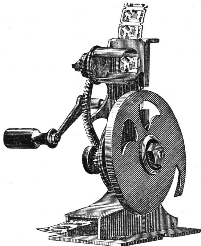
On place le Mirographe sur le socle où on l'assujettit au moyen de la clef placée sous l'appareil, on place la pellicule sur le rouleau et on en introduit l'extrémité dans le couloir en tournant la manivelle dans le sens des aiguilles d'une montre et on regarde par l'oculaire.
