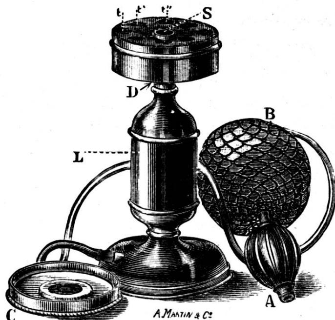
la poire A, on arrive à avoir dans la poire B une forte provision d'air. On lâche alors le caoutchouc et l'air s'échappe par l'orifice S en entraînant le magnésium qui s'allume au travers de la flamme.
