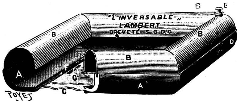
*Légende* : A. Socle de la cuvette. — B. Recouvrement. — C. Fond en verre transparent. — D. Crochet. — E. Orifice pour l'écoulement du liquide. — F. Cavité ménagée pour sortir le cliché avec le crochet D. — G. Cliché.
