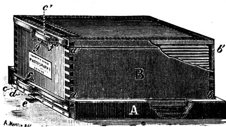
*a' b'*. Le magasin est garni de porte-plaques en tôle dans lesquels les plaques sont placées, la couche en dehors.
