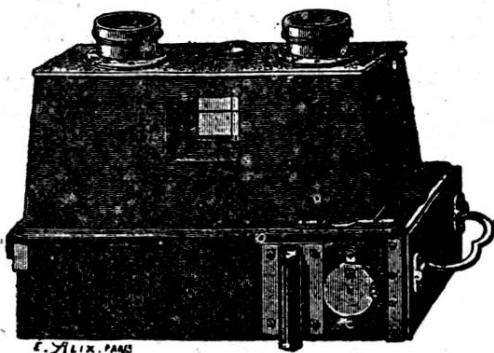
l'idée d'utiliser les objectifs même de l'appareil pour regarder les épreuves positives sur verre obtenues par son moyen. Pour cela, le magasin qui contient douze plaques est enlevé et remplacé par un cadre qui supporte les positifs sur verre. Ces images sont tirées dans un châssis spécial qui place rigoureusement les clichés à l'écartement qu'ils doivent avoir.
